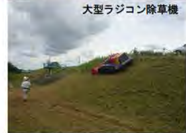
平成24年度 堤防除草実施状況
