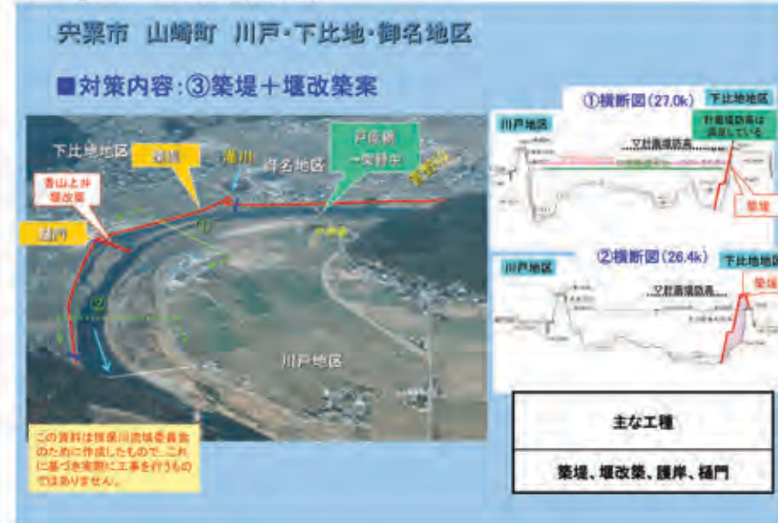
図6 ③築堤+堰改築案の内容
