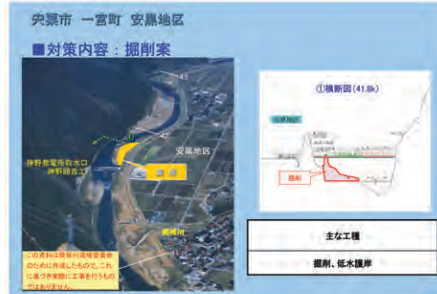
図10 掘削案のみの例
