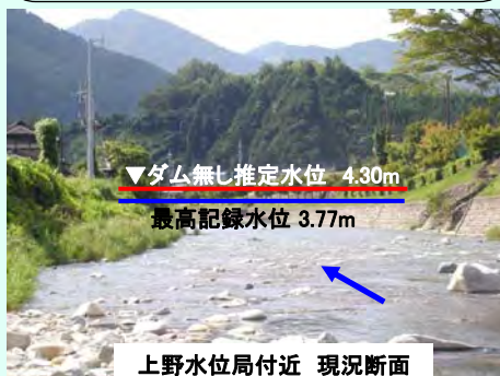
台風9号における引原ダム洪水調節効果 (上野水位局における水位低減効果)
