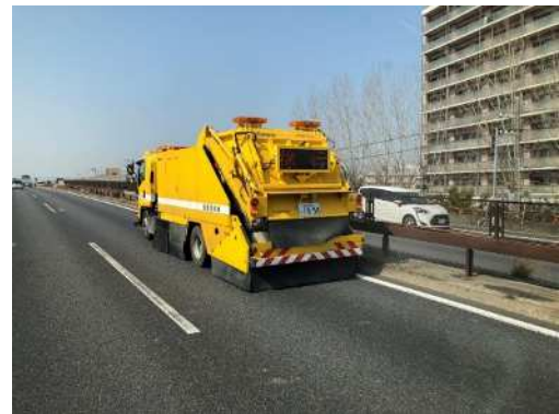
路面清掃状況
