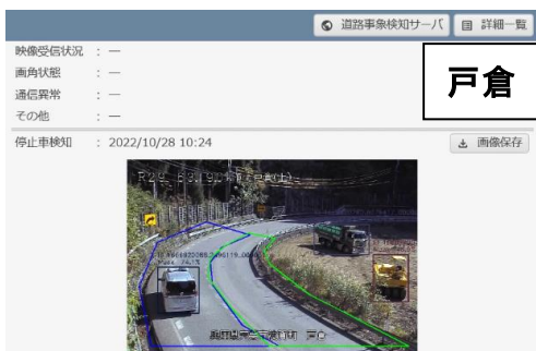
AI 検知カメラによる停止車両の検知
