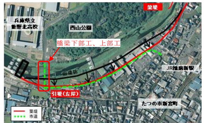
築堤・橋梁架替箇所(新宮他地区)
