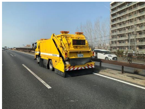
路面清掃状況
