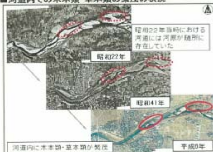
図 3.13 河道内での木本類・草本類の繁茂状態
