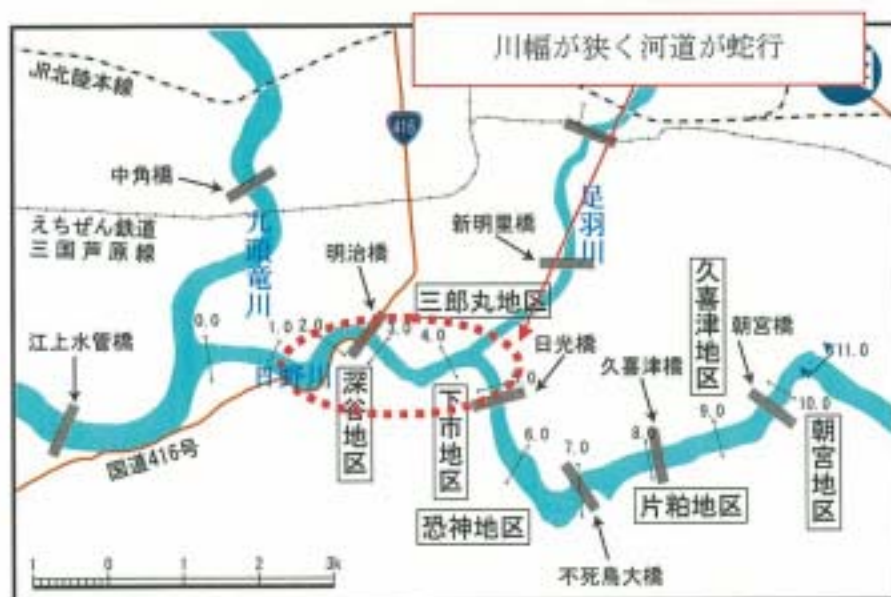
図3.2 日野川の流下能力改善必要箇所
