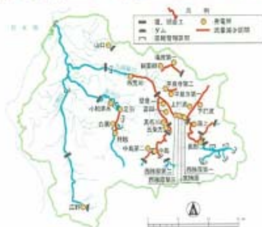
図3.20 発電取水による流量減少区間
