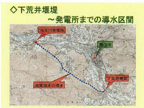
図3.35 下荒井堰堤～発電所までの導水区間の導水区間
