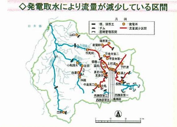
図3.44 発電取水により流量が減少している区間
