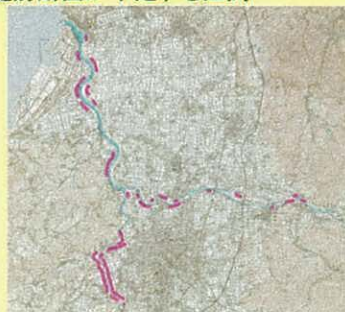
◇堤防断面が不足する区間
