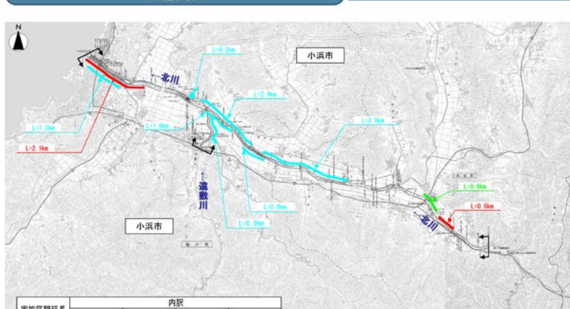
洪水を安全に流すためのハード対策 概要図 <北川>
