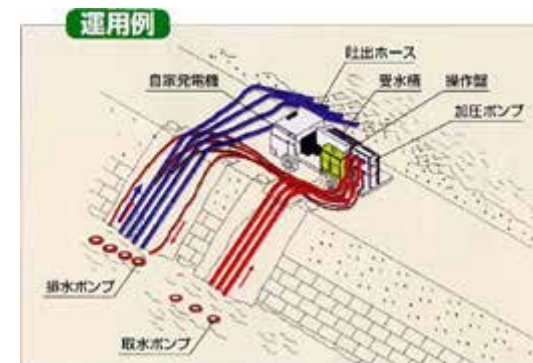
排水ポンプ車 運用例
