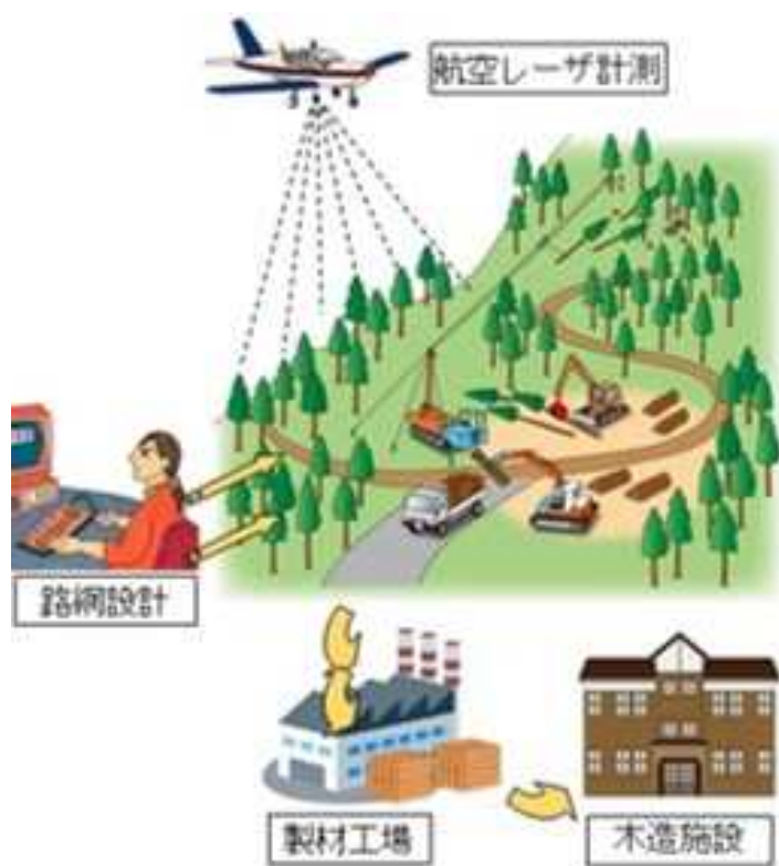
山間部における航空レーザ測量のイメージ
