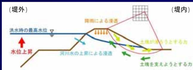
堤内側のり面破壊照査
