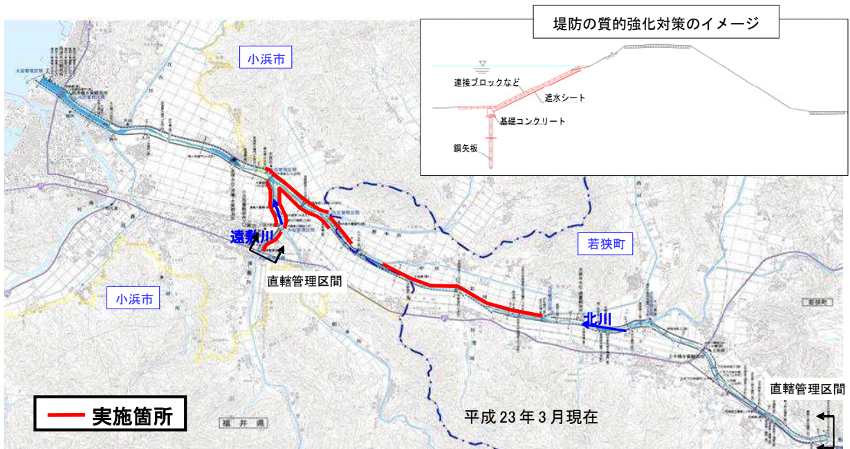
図 4.1.6 堤防安全性確保実施予定箇所
