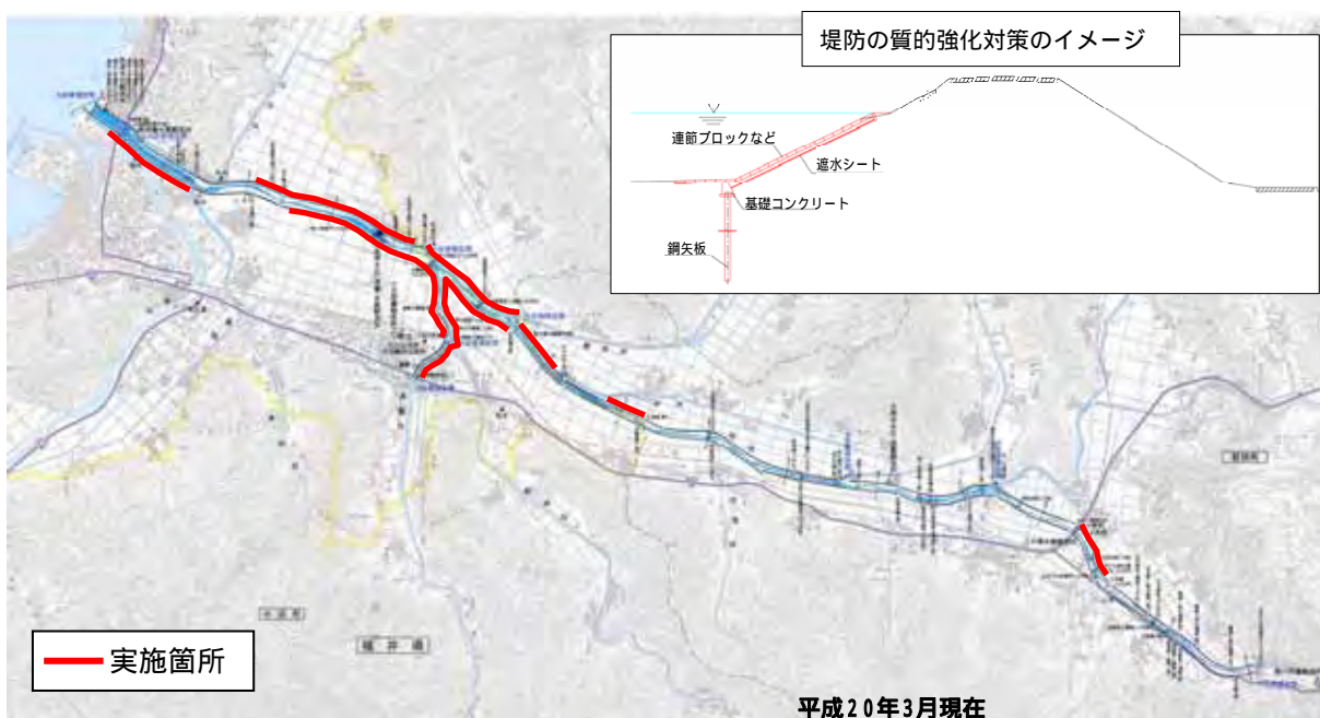
図 4.1.6 堤防安全性確保実施予定箇所
