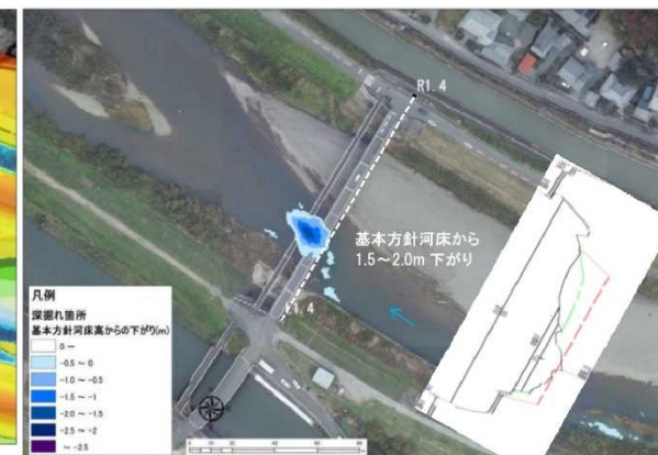
図 6.32 丸山橋 橋脚基礎部の洗濯状況
