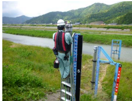
水位観測所点検状況
