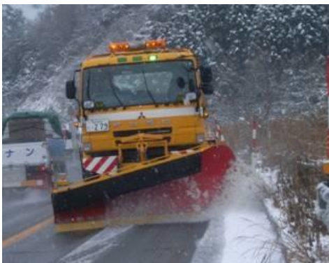
路面の積雪を排除する除雪トラック
