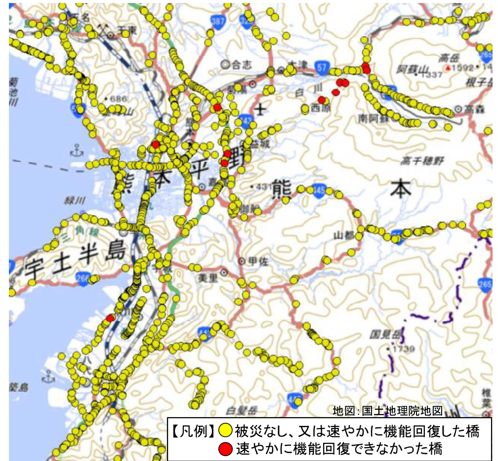
図-1 緊急輸送道路の橋の耐震性能の発揮状況 (熊本県内で震度6弱以上を観測した主要地域)
