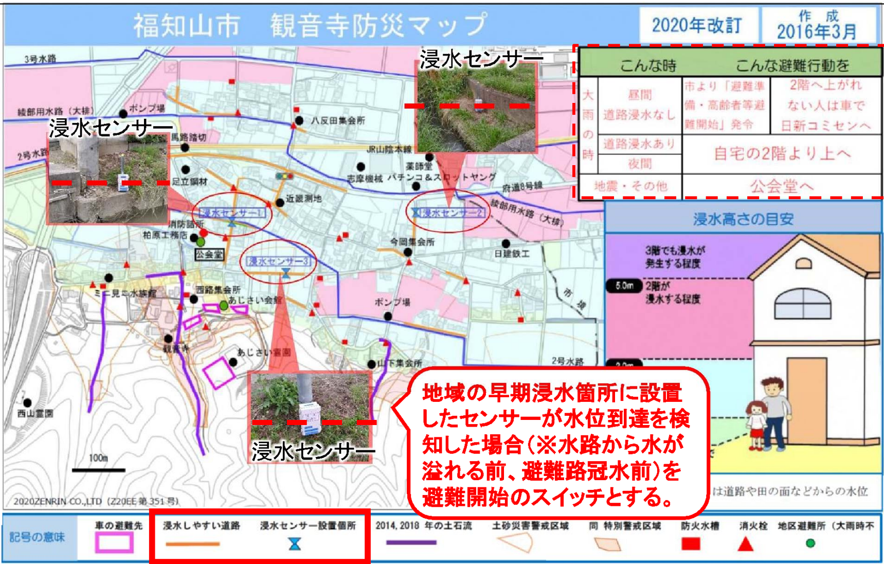
この図は2016年発行の「観音寺マイマップ」に浸水センサーの位置と2018(H18)年の土石流を追記したものです。浸水想定は「100年に一度」の規模の大雨の場合の浸水予測です。
