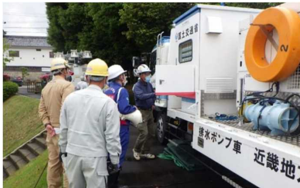
▲排水ポンプ車の操作
