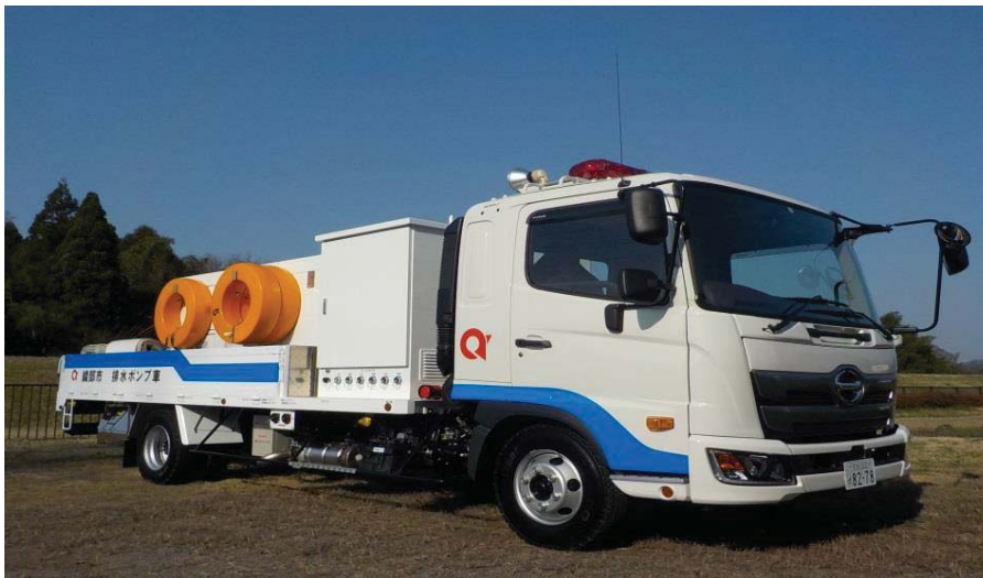
排水ポンプ車の配備(H30.3)
