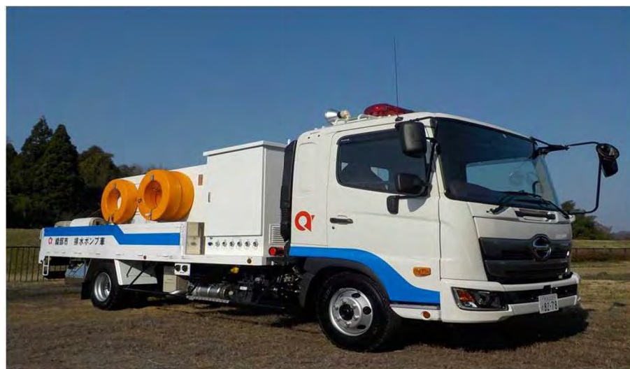
排水ポンプ車(H30.3)
