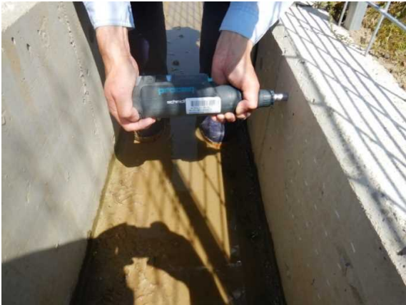
テストハンマーによる強度測定
