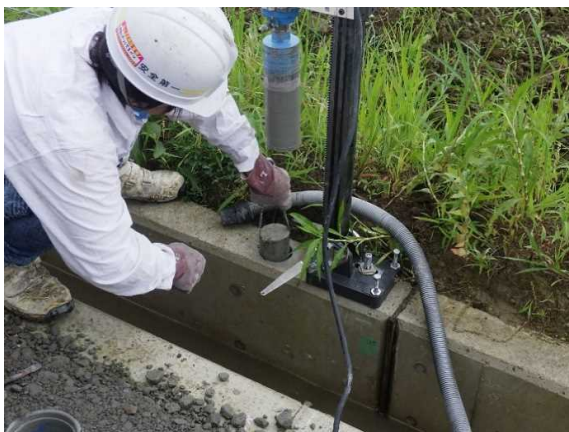
強度試験用のコアの採取
