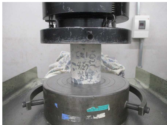
公的試験機関での圧縮強度試験
