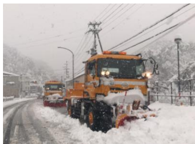
新雪除雪（除雪トラック）
