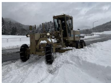
拡幅除雪（除雪グレーダ）
