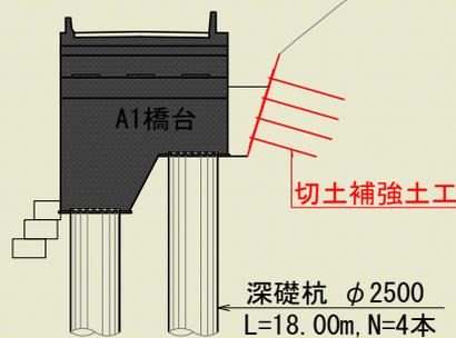
深礎杭は大型機械が入れない場所で施工する工法です。本工事では深さ18.0mの杭を4本、人力で掘削します。
