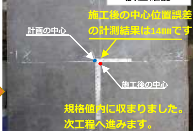
光波測距儀での杭芯のズレ測定
