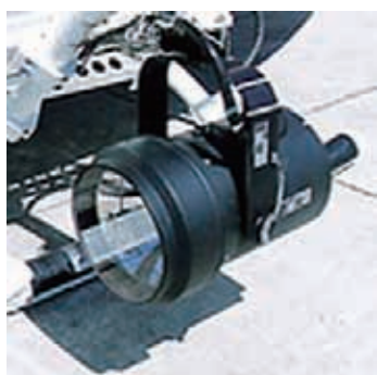
サーチライト装置
