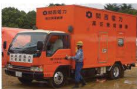
発電機車（50/60Hz切替式）
