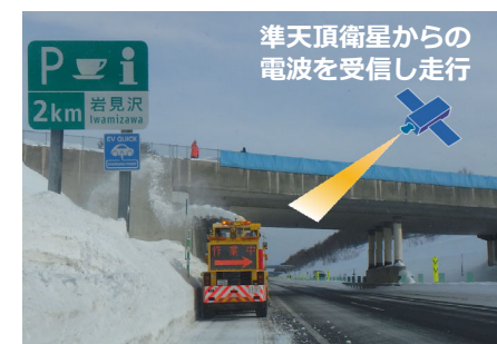
道央道でのICT除雪技術の実験状況
