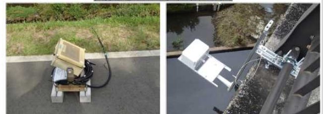
堤防に設置するタイプ (ケーブル(計測器)を河川に入れて計測)
