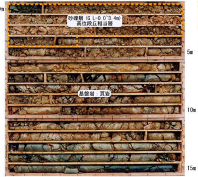
鉛直ボーリング No. 96 のコア状況
