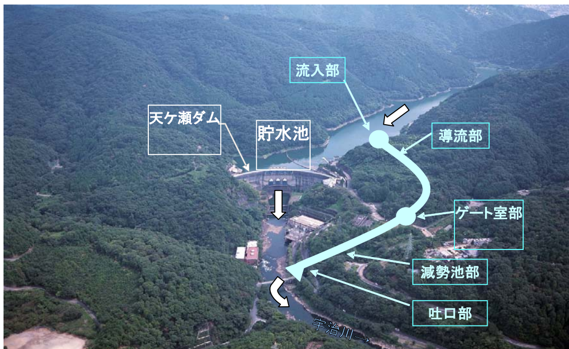
図 2-7 トンネル式放流概要図(施設配置図)
