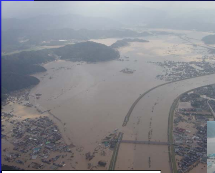
円山川右岸13.2km付近の破堤の状況
