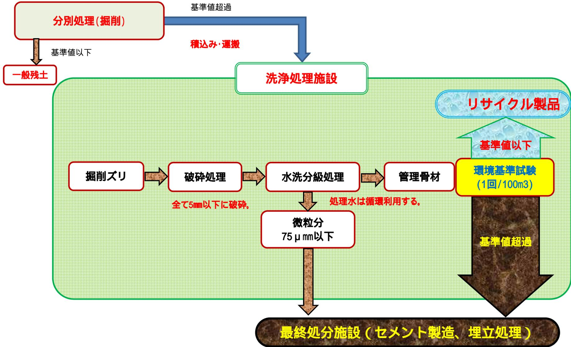
リサイクル製品：コンクリート用骨材や路盤材等の土木材料の一部として再利用。
