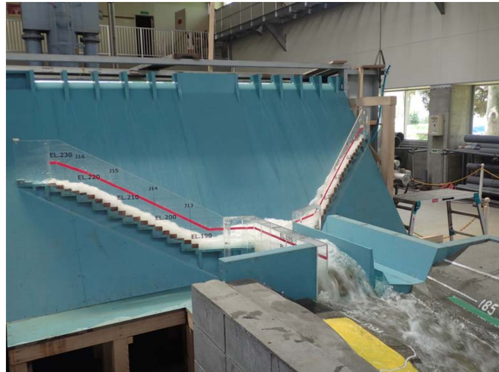
ダム本体水理模型実験状況
