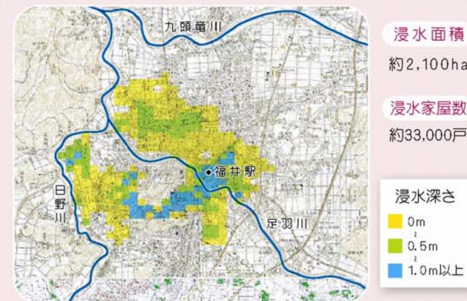
現況の河道・施設で戦後最大規模の洪水(福井豪雨を含む)が発生した場合の浸水想定区域
