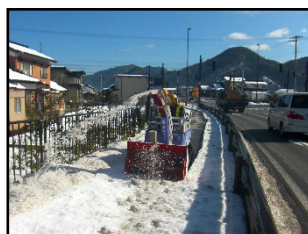
歩道除雪 (小型除雪機)
