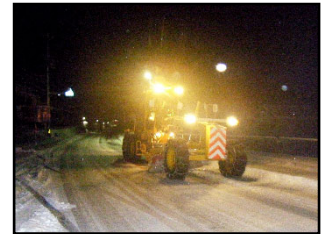
拡幅除雪 (除雪グレーダ)
