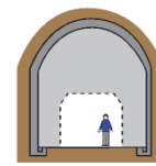
足田トンネル（現況）歩道として活用
